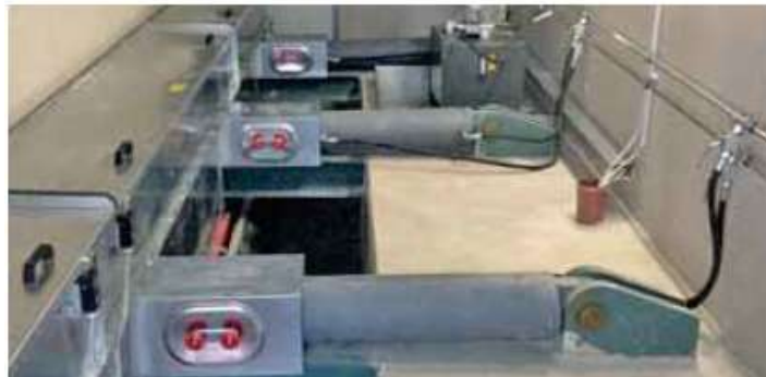
Vérins hydrauliques robustes pour le mouvement du fond racleur
