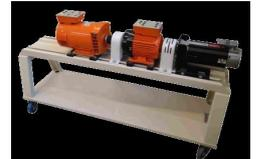
Il est possible de mesurer les grandeurs électriques courant, tension, puissance, énergie en monophasé comme en triphasé aussi bien sur des charges passives de type R, L et ou C, mais également sur 12 bancs moteurs (alternateur, moteur asynchrone et à courant continu)
